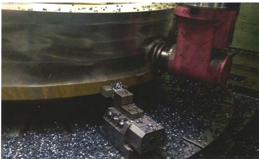
Bild 3: Wie bei dieser Drehfräs-Operation mit dem ZCC-CT Planfräser D=315,0 mm, 60°, bietet die MILLTEC GmbH eine kundenorientierte technische Unterstützung vor Ort
