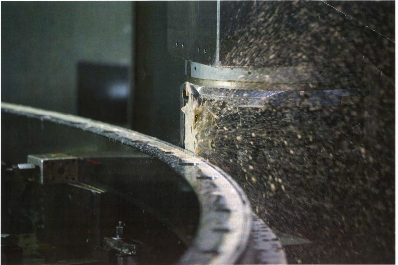
Bild 1: Schwer im Einsatz: Bei der LEIPERT Maschinenbau GmbH in Kraichtal müssen die eingesetzten Werkzeuge lange Standzeiten aber auch höchste Präzision liefern – im Verbund mit der Portalmaschine bis auf wenige Hundertstel genau
