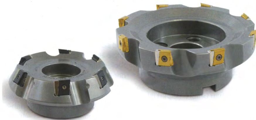
Bild 2: Die hocheffizienten und universellen Wendeschneidplatten der ZCC Cutting Tools Europe GmbH ersetzen bei Leipert die bisherigen drei WSP-Typen. Damit werden Lagerhaltungskosten eingespart und das allgemeine Handling optimiert (Werkbild: ZCC Cutting Tools Europe GmbH)
