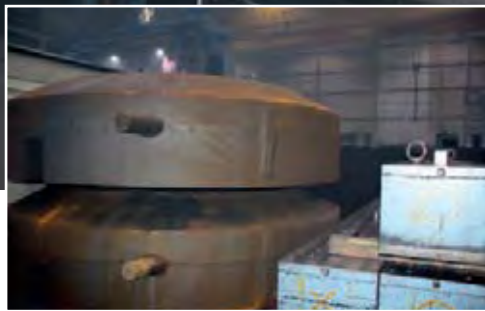
Das Rohteil besteht aus unlegiertem Eisen mit einem sehr hohen Reinheitsgrad.
